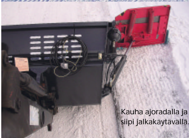
Kauhan takakulmaa voi nostaa 400 mm siipien pintakosketuksen silti säilyessä.
