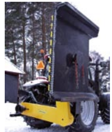
Kaksinkertainen suojakotelon runko on HARDOX® kulutusterästä ja kaksi järeää ketjua murskaa tehokkaasti piennarvesakon.
