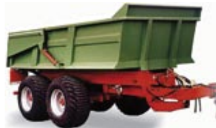
Urakointivaunu PB on Domex-laaturästä, pohjalevy 8 mm ja laidat 5 mm.
